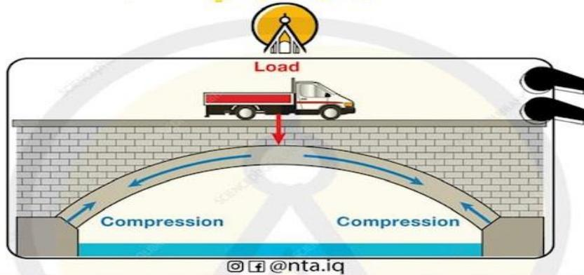
\* على الأرجح هذا النوع هو أقدم أنواع الجسور، ويقوم بحمل الأحمال أولاً عن طريق الضغط و من ثم تنقل إلى الأساسات بقوة رأسية و قوة أفقية ، لذلك يجب أن تكون أساسات هذا الجسر تمنع الحركة الأفقية (الانزلاق) و الحركة الرأسية (الهبوط)، على الرغم من صعوبة تصميم أساسات هذا الجسر ، إلا أن هيكل الجسر نفسه يحتاج مواد أقل مما يحتاجها الجسر ذو الكمرات بنفس (SPAN-البحر) .
