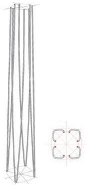
巨型支撑结构 Mega-Columns
