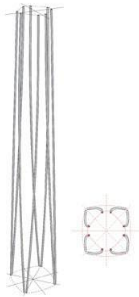
巨型支撑结构 Mega-Columns
